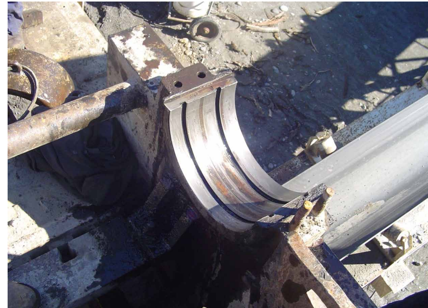
Reparación de Descanso de chancadora (Muela)
