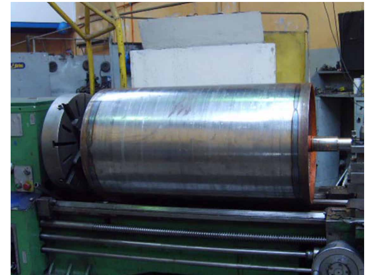
Fabricación de rodillos tensores de correas transportadores de diferentes dimensiones y características.
