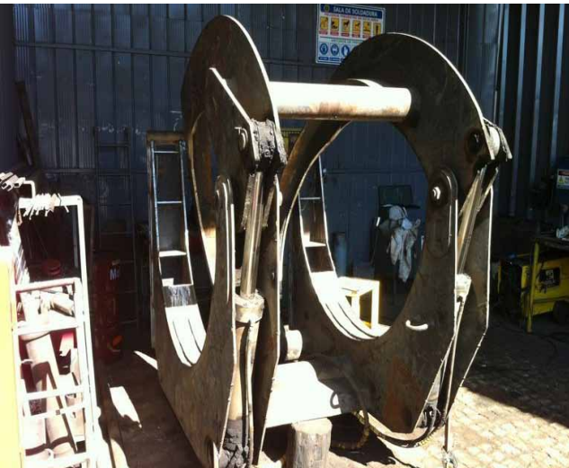
Reparación de Garras Cargador Frontal
