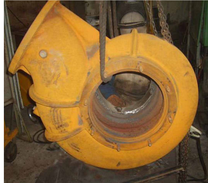
Recuperación y posterior mecanizado a volutas de bomba de diferentes modelos, cuyo material es hierro fundido.
