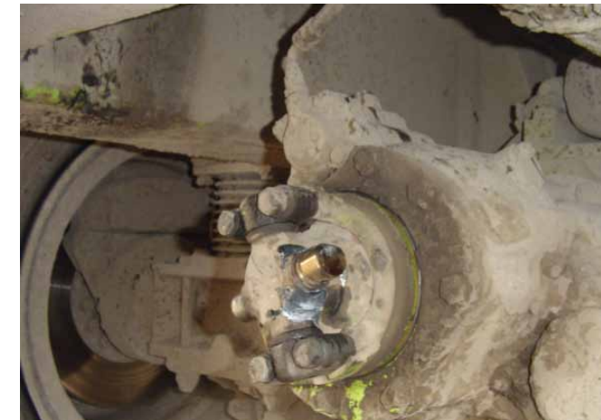
Reparación de juntas Cardanicas
