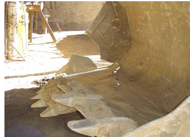
Reparación de Balde de Cargador Frontal
