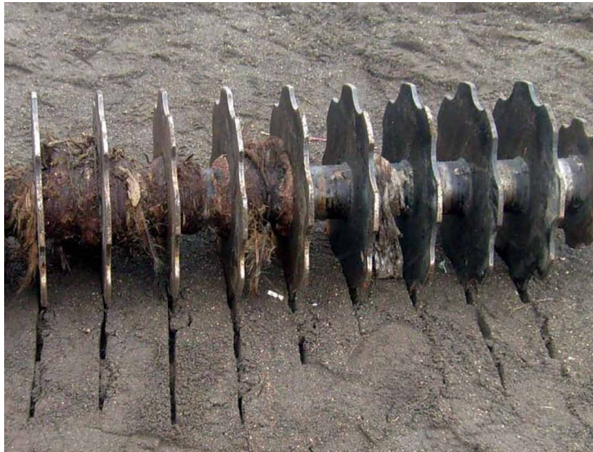
Reparación de ejes motrices y armado de conjunto de eje harneros de discos
