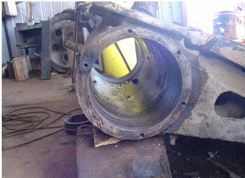
Reparación de elementos pivotantes de chancadora (Muela)
