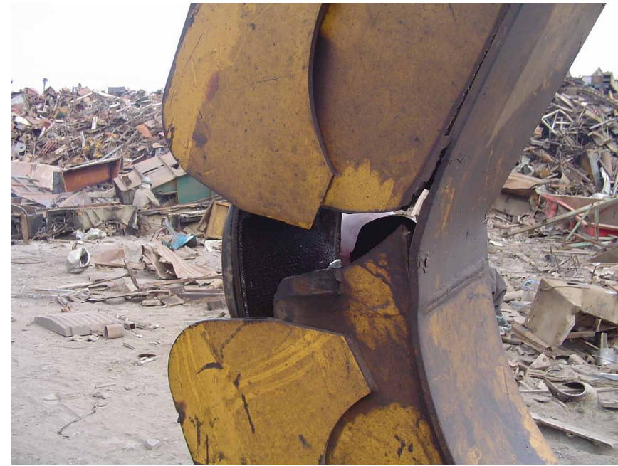
Reparación de fractura de Grúa Liebherr Oruga
