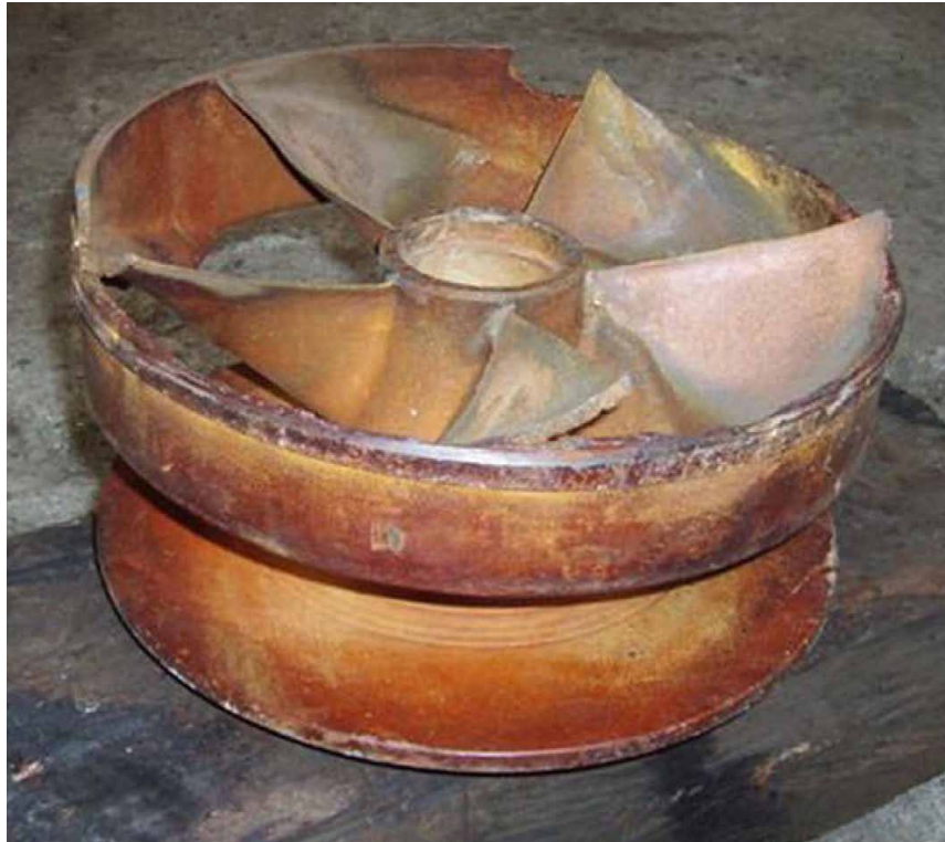
Recuperación, mecanizado y posterior balanceo de álabes de impulsor de bombas centrífugas.
