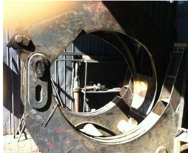
Reparación de Garras Cargador Frontal
