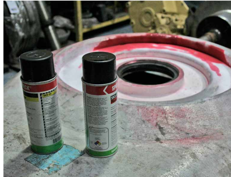
Inspecciones No Destructivas, esta foto muestra una grieta en una corona de reductor, cuya reparación se efectúa según muestra original
