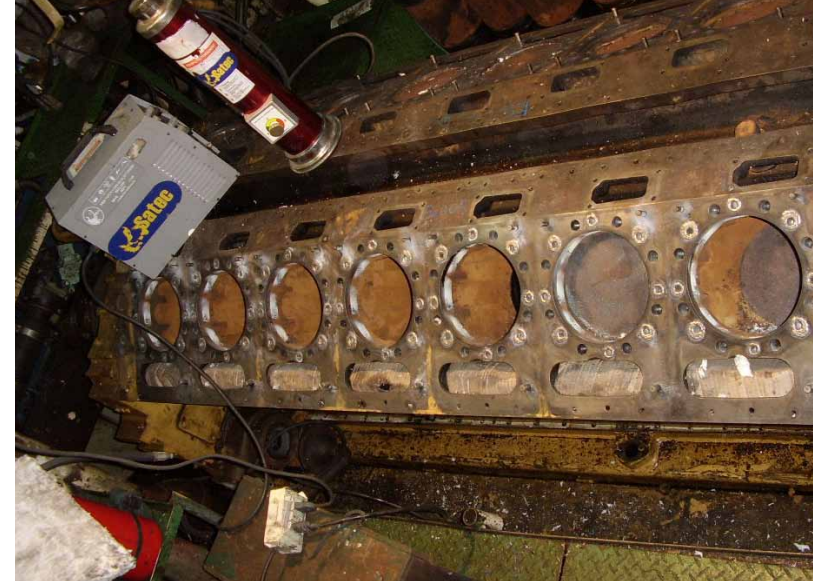
Reparación de block de Motor en Pasada de Agua de Enfriamiento. Sistema con Arco Manual (Material Fierro Fundido)
